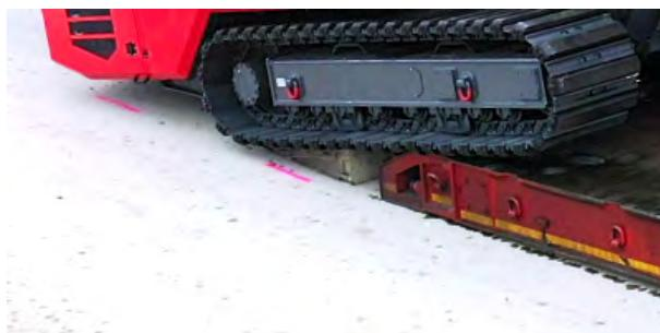
9. Fahren Sie die Maschine mit Hilfe der Errichtefernbedienung von der Ladefläche auf die Rampe.
