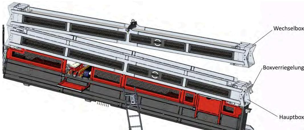
Abb. 7-38: Wechselbox montieren
