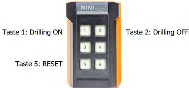
Abb. 7-20: Stilllegungssystem - Bedienung
