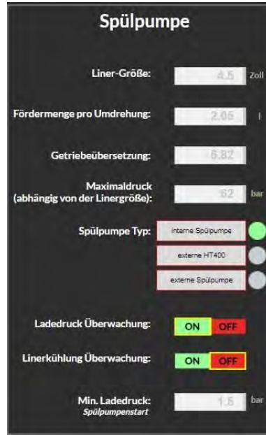
Abb. 7-32: Spülungspumpe konfigurieren
