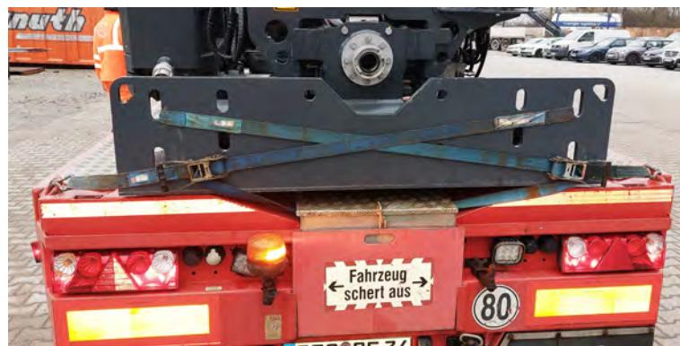
Abb. 7-16: Verzurrte Ankerplatte
