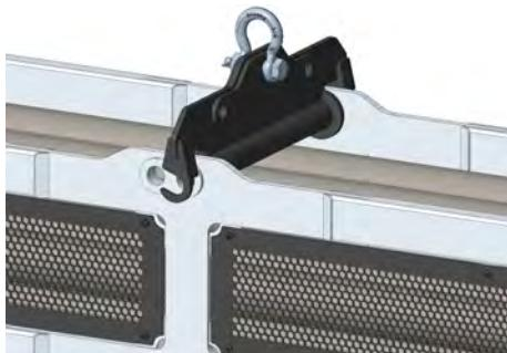
2. Bolzen mit Griffblech schräg ansetzen und Bolzen durch Wechselbox und Anhängevorrichtung durchstecken bis das Griffblech an der Box anschlägt.
