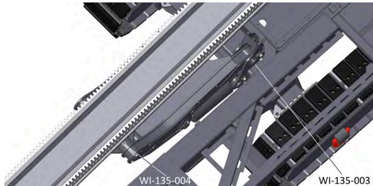
Abb. 8-4: Bohrmastverstellung 135
