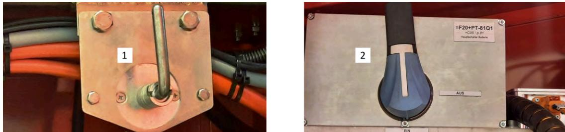
Abb. 5-22: Batteriehauptschalter
