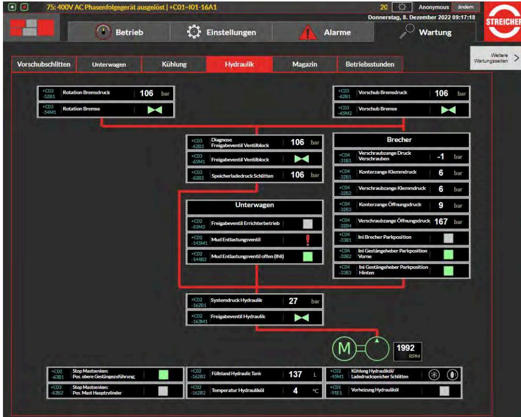
Abb. 6-13: Wartung - Hydraulik
