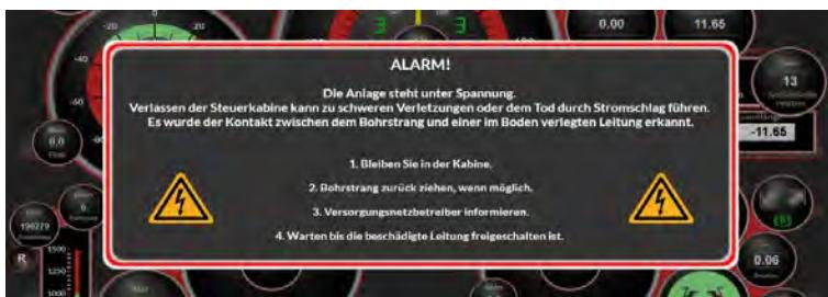
Abb. 7-56: Visualisierungsmeldung Stromschlagdetektor
