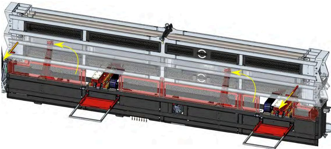
Abb. 7-39: Gestängebox anhängen und heben
