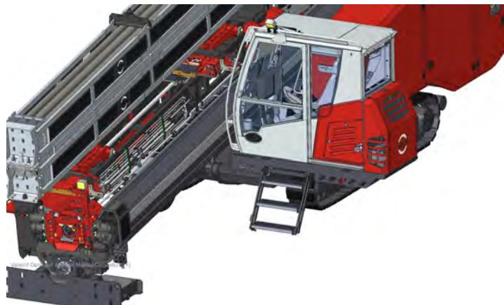
Abb. 7-44: Steuerkabine in Betriebsposition bringen
