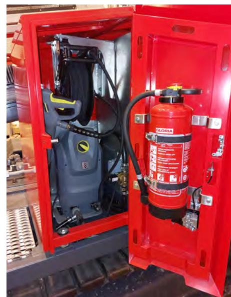
Abb. 4-17: Hochdruckreiniger
