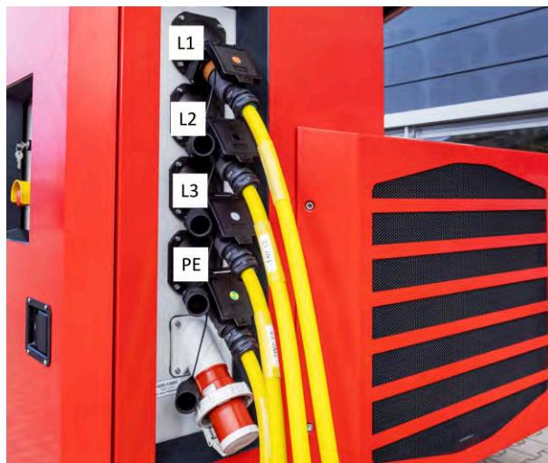
Abb. 7-5: Versorgung Netzbetrieb
