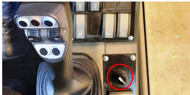
9. Fahren des Vorschubschlittens aus dem Bewegungsbereiches der Gestängezuführung mit Joystick [VS04].
