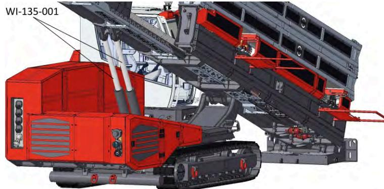
Abb. 8-6: Bohrmastverstellung 135
