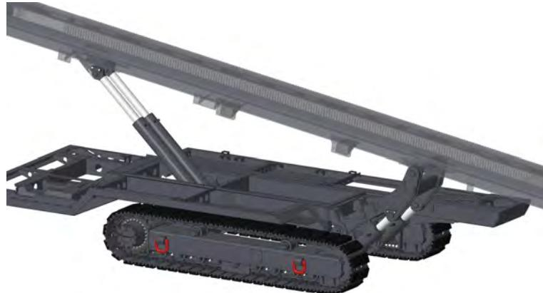
Abb. 4-6: Bohrmastverstellung
