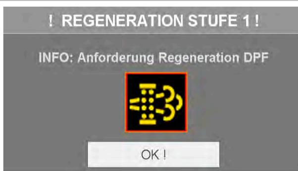
Anschließend startet die Regenerationsstufe 2: Drücken sie auf die Schaltfläche [OK !]
