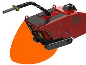
Abb. 2-2: Gefahrenbereich während des Entleeren des Abraumtanks (Kippen)
