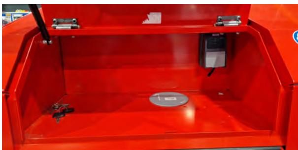
Abb. 4-9: Ladegerät Akku Fernbedienung
