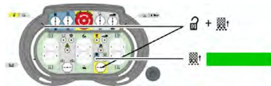
Entriegeln Sie die Rotationsachse des Saugarms.
