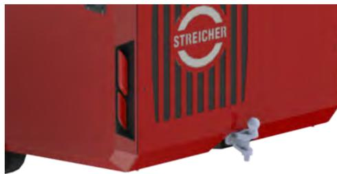
Abb. 5-4: Lasten anhängen/abschleppen
