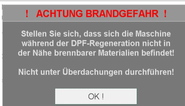
Anschließend startet die Regenerationsstufe 1: Drücken sie auf die Schaltfläche [OK !]
