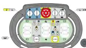
Drehen Sie den Schlüsselschalter [PW03] ZÜNDUNG in Stellung '2'.
