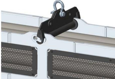
2. Bolzen mit Griffblech schräg ansetzen und Bolzen durch Wechselbox und Anhängervorrichtung durchstecken bis das Griffblech an der Box anschlägt.
