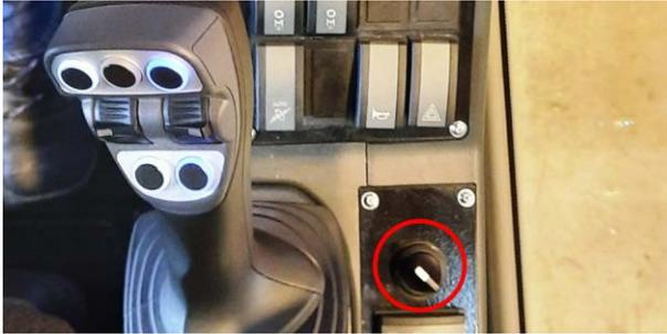
9. Fahren des Vorschubschlittens aus dem Bewegungsbereich der Gestängezuführung mit Joystick [VS04].
