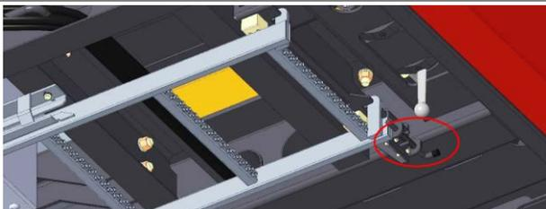
3. Hängen Sie bei Bedarf das Verlängerungsstück der Leiter ein. Das Verlängerungsstück befindet sich am Raupenunterwagen, im Bereich unter der Spülungspumpe. Um die Leiter herauszunehmen lösen Sie die Arretierung und ziehen Sie die Leiter aus der Führungsschiene.
