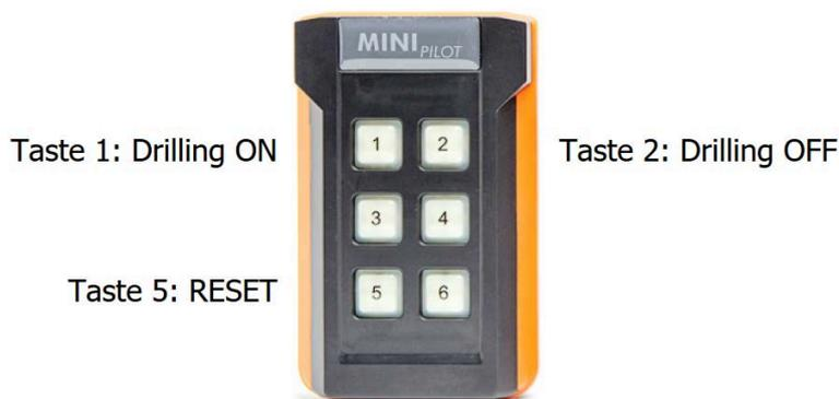
Abb.7-21: Stilllegungssystem - Bedienung
