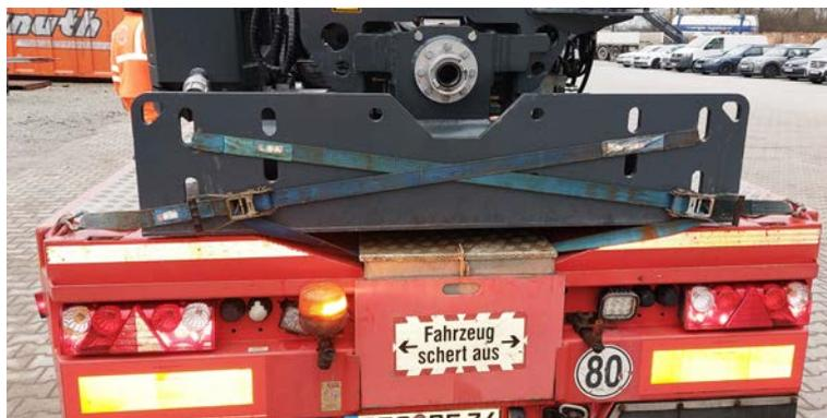
Abb.7-16: Verzurrt Ankerplatte
