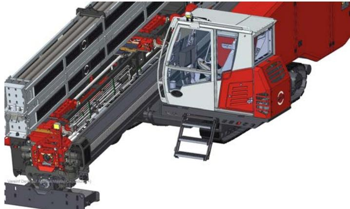
Abb.7-45: Steuerkabine in Betriebsposition bringen
