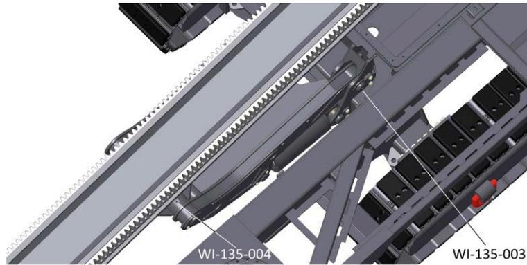
Abb.8-4: Bohrmastverstellung 135
