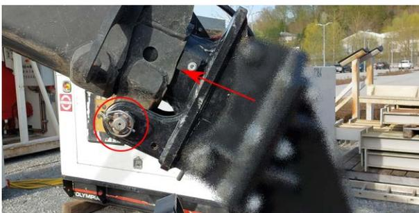
3. Nehmen Sie den Greifer mit dem Schnellwechsler auf und sichern Sie den Greifer.
