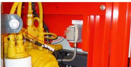
3. Schließen Sie das Rückmeldesignal "Ladepumpe läuft" der externen Ladepumpe am potentialfreien Kontakt an. (siehe *Kapitel Elektrische Schnittstellen und Versorgung Seite 14*).
