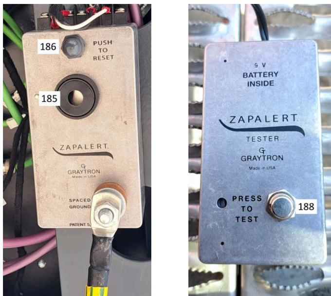
Abb. 5-21: Stromschlagdetektor
