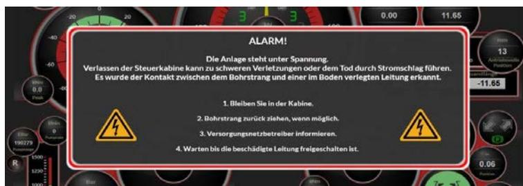
Abb. 7-44: Visualisierungsmeldung Stromschlagdetektor
