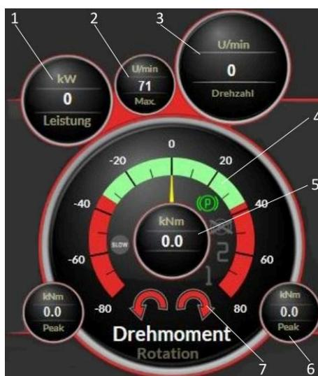
Abb. 7-24: Rotation Visualisierungsanzeigen
