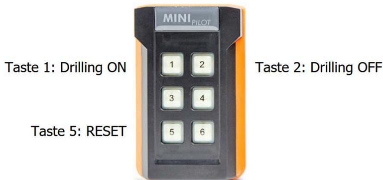
Abb. 7-16: Stilllegungssystem - Bedienung
