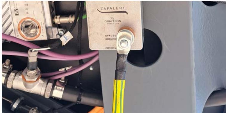
Abb. 7-43: Anker und Auswertung verbinden
