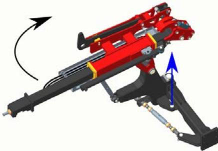
3. Positionieren Sie das Spannschloss und stecken Sie den Arretierbolzen.
