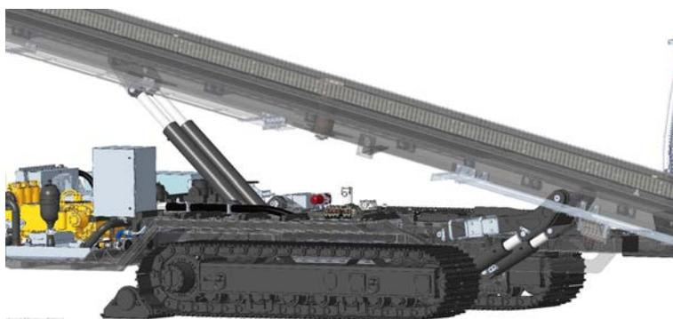
Abb. 4-6: Bohrmastverstellung
