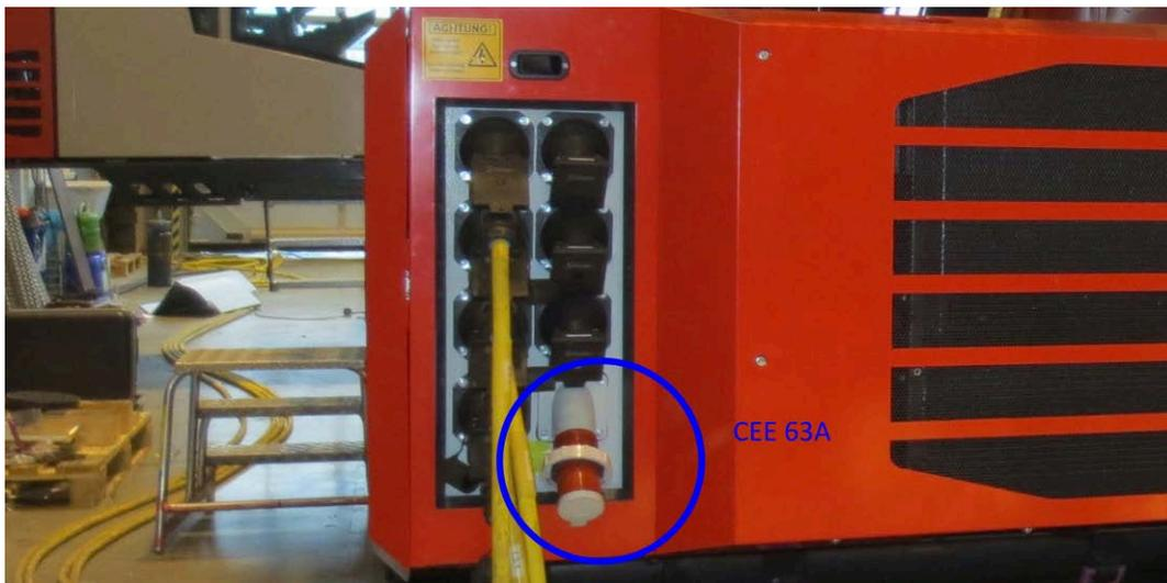
Abb. 7-7: Hilfsversorgung Netzbetrieb
