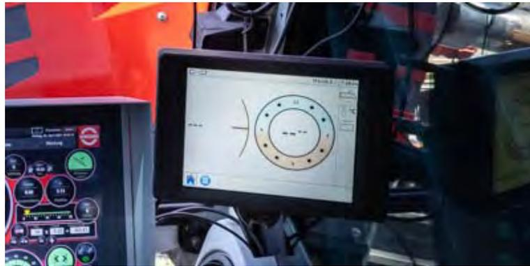
Abb. 5-17: Richtbohrpanel
