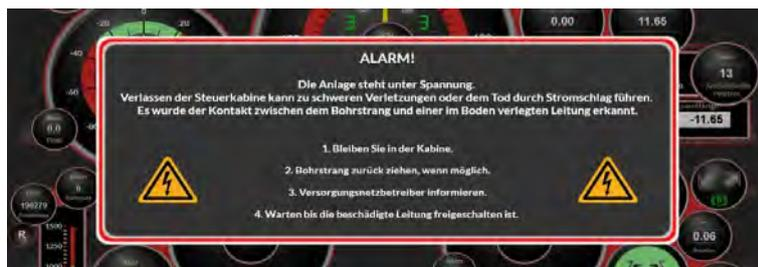
Abb. 7-57: Visualisierungsmeldung Stromschlagdetektor
