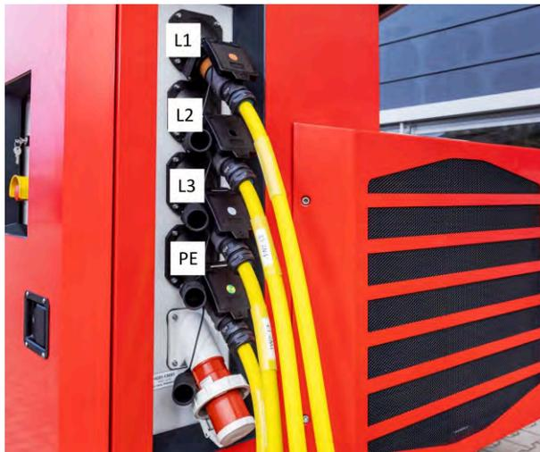
Abb. 7-5: Versorgung Netzbetrieb
