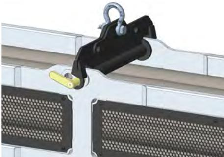
3. Bolzen mit Griffblech zur Sicherung nach unten drehen.
