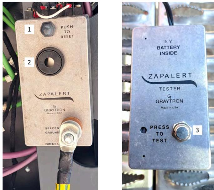
Abb. 5-25: Stromschlagdetektor
