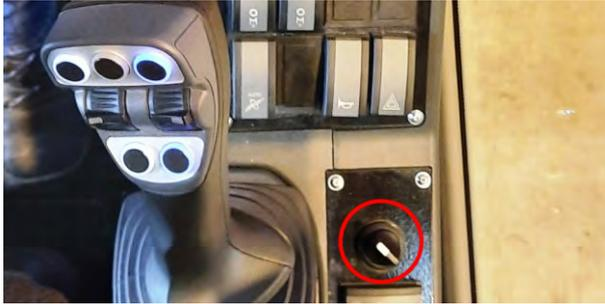
9. Fahren des Vorschubslittens aus dem Bewegungsbereiches der Gestängezuführung mit Joystick [VS04] .
