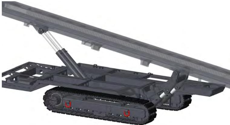
Abb. 4-6: Bohrmastverstellung
