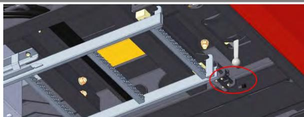
3. Hängen Sie bei Bedarf das Verlängerungsstück der Leiter ein. Das Verlängerungsstück befindet sich am Raupenunterwagen, im Bereich unter der Spülpumpe. Um die Leiter herauszunehmen lösen Sie die Arretierung und ziehen Sie die Leiter aus der Führungsschiene.
