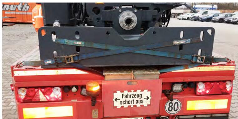
Abb. 7-16: Verzurrte Ankerplatte
