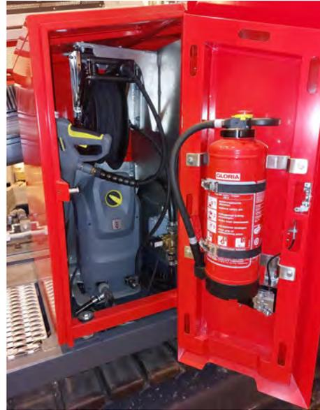
Abb. 4-17: Hochdruckreiniger
