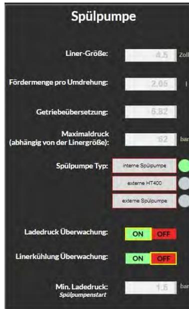
Abb. 7-33: Spülpumpe konfigurieren
