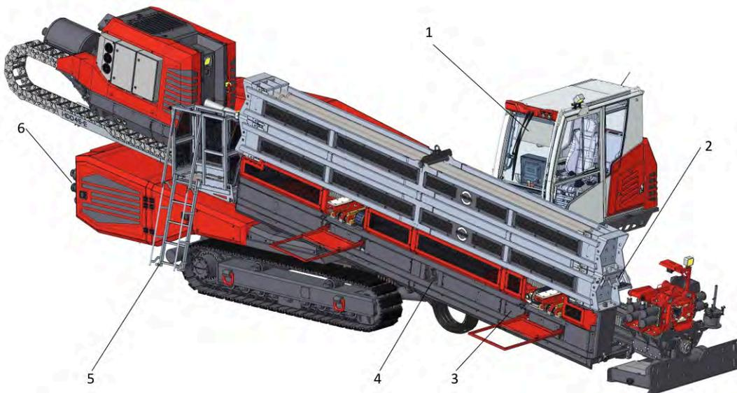
Abb. 5-2: Bedienorte Bohrbetrieb
