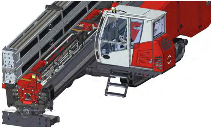
Abb. 7-45: Steuerkabine in Betriebsposition bringen
