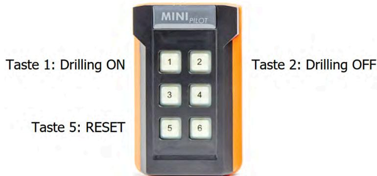
Abb. 7-21: Stilllegungssystem - Bedienung
