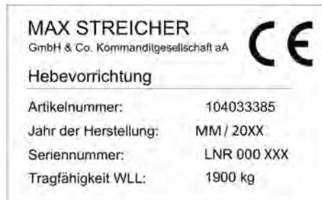
Abb. 2-6: Typenschild - Hebetraversen Box
