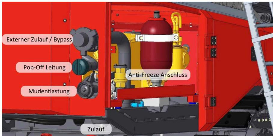
Abb. 7-32: Anschlüsse Spülpumpe
