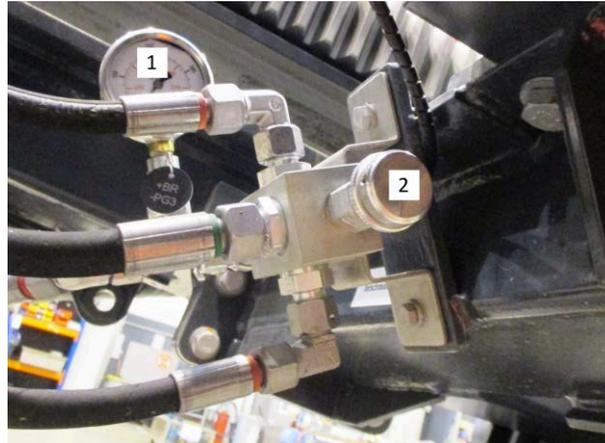
Abb. 5-24: Druckeinstellung Brecher
