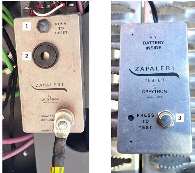
Abb. 5-25: Stromschlagdetektor
