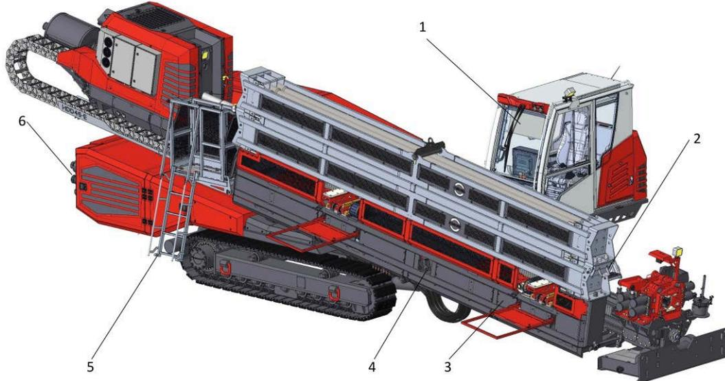
Abb. 5-2: Bedienorte Bohrbetrieb
