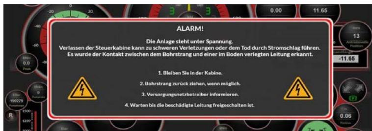
Abb. 7-57: Visualisierungsmeldung Stromschlagdetektor
