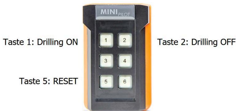
Abb. 7-21: Stilllegungssystem - Bedienung
