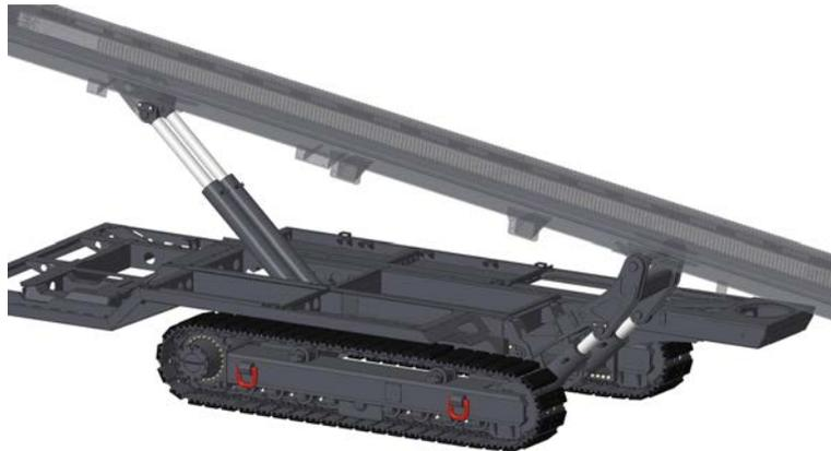
Abb. 4-6: Bohrmastverstellung
