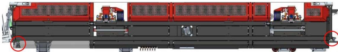
Abb. 7-44: Ablaufschläuche am Gestängemagazin
