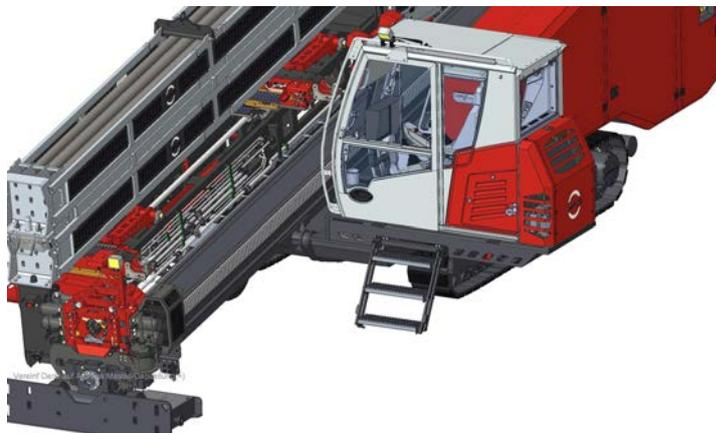
Abb. 7-45: Steuerkabine in Betriebsposition bringen
