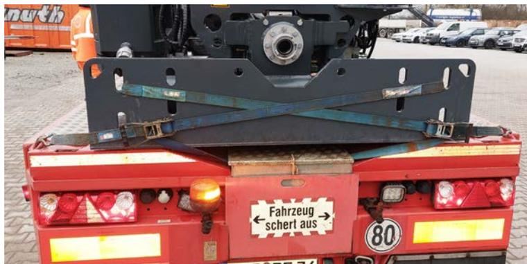
Abb. 7-16: Verzurrte Ankerplatte
